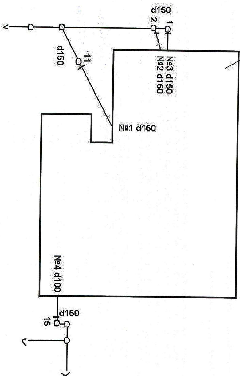
Граница эксплуатационной ответственности сторон устанавливается по линии раздела элементов систем канализации согласно схеме Схема канализации и №№ канализационных колодцев указаны в соответствии с документами: Акт № 7.2241.
