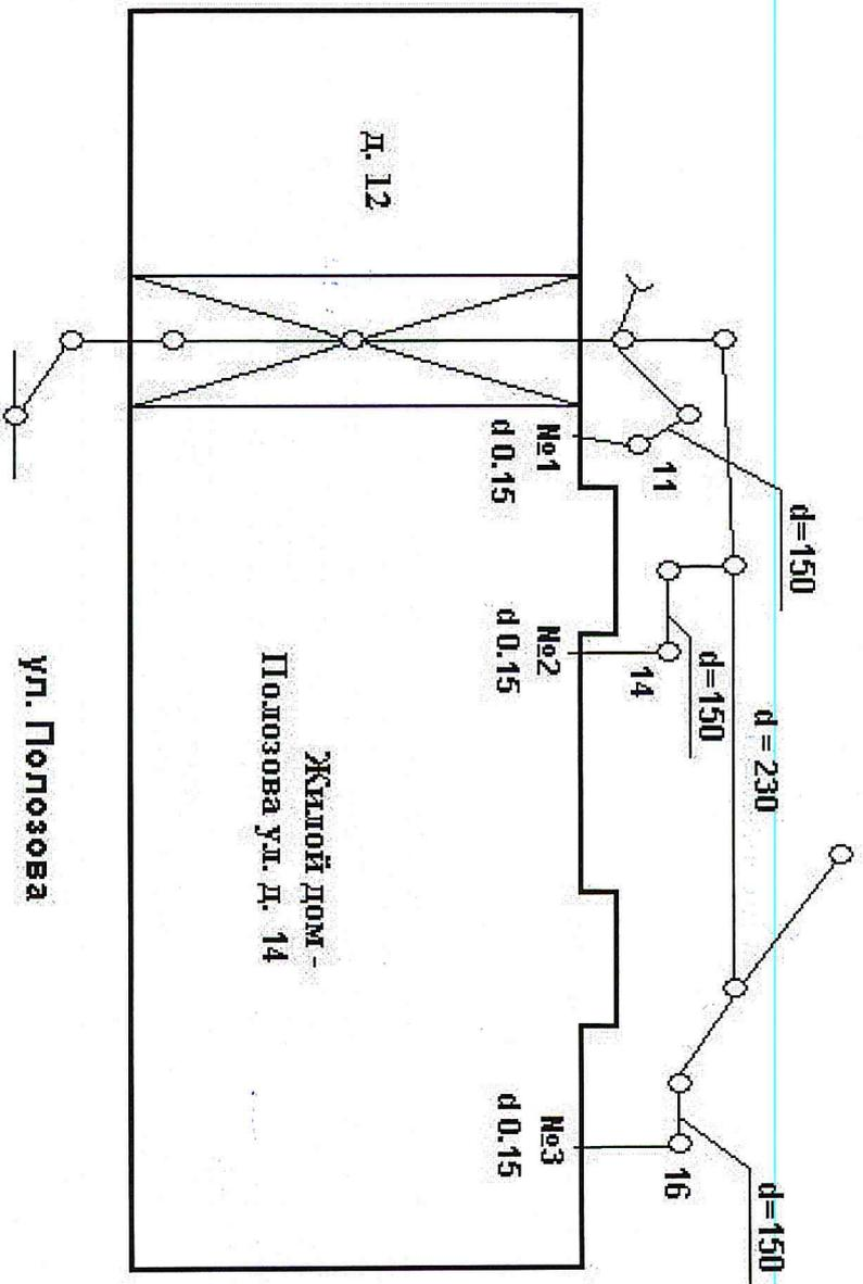
Граница эксплуатационной ответственности сторон устанавливается по линии раздела элементов систем канализации согласно схеме Схема канализации и №№ канализационных колодцев указаны в соответствии с документами: Акт № 7.1242.
