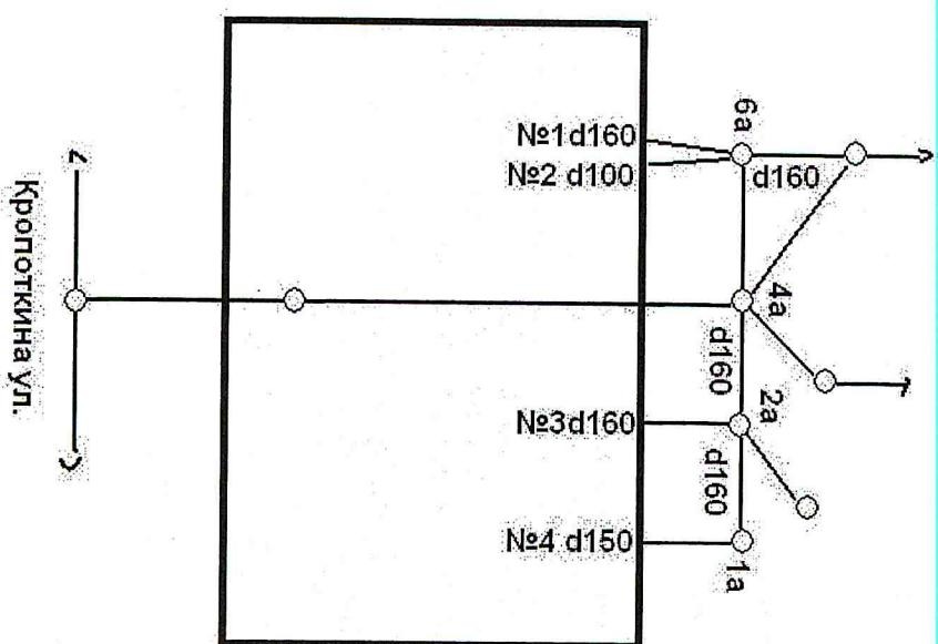
Граница эксплуатационной ответственности сторон устанавливается по линии раздела элементов систем канализации согласно схеме Схема канализации и №№ канализационных колодцев указаны в соответствии с документами: Акт № 7.1216.
